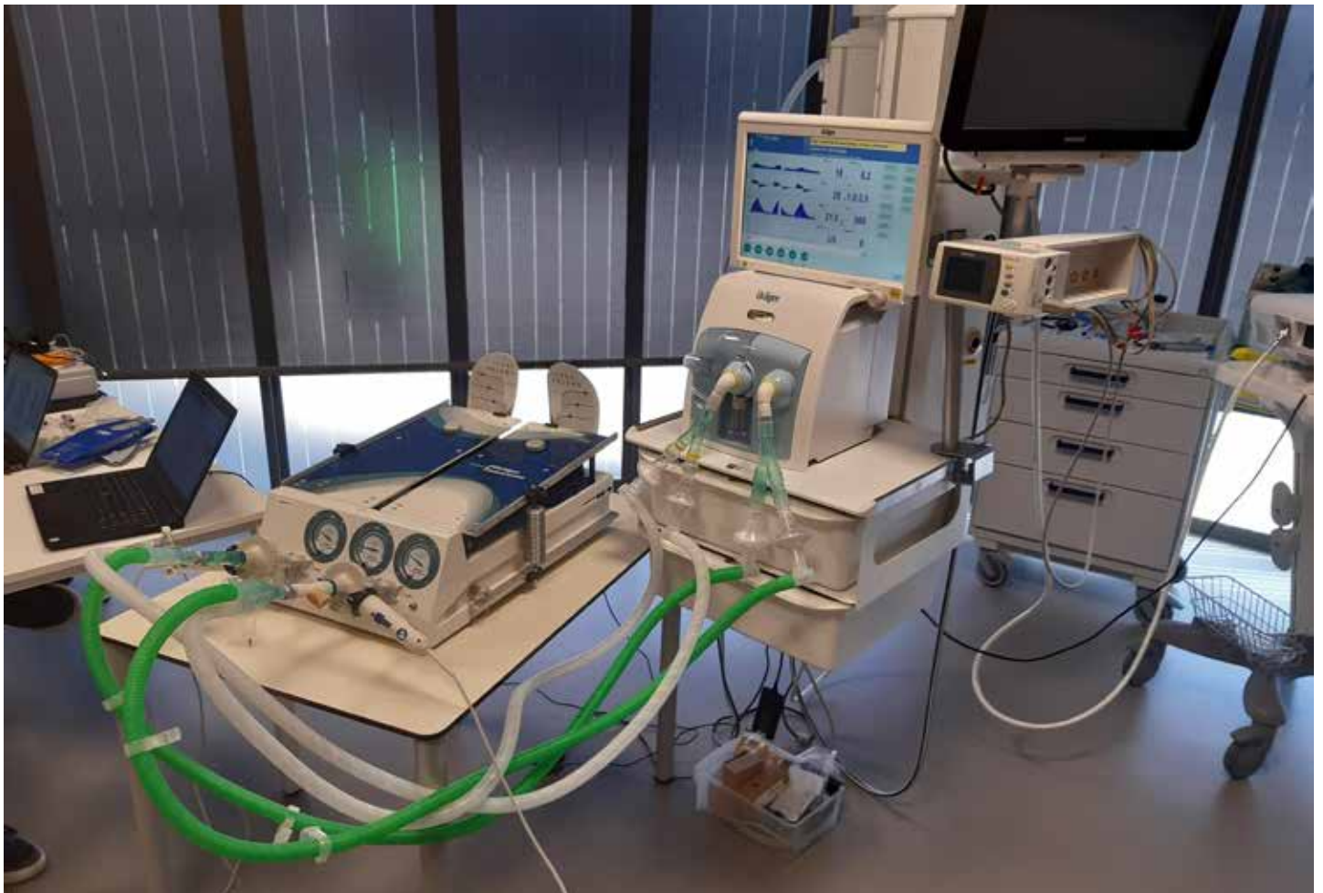
Project met één ventilator twee patiënten tegelijk te beademen.
